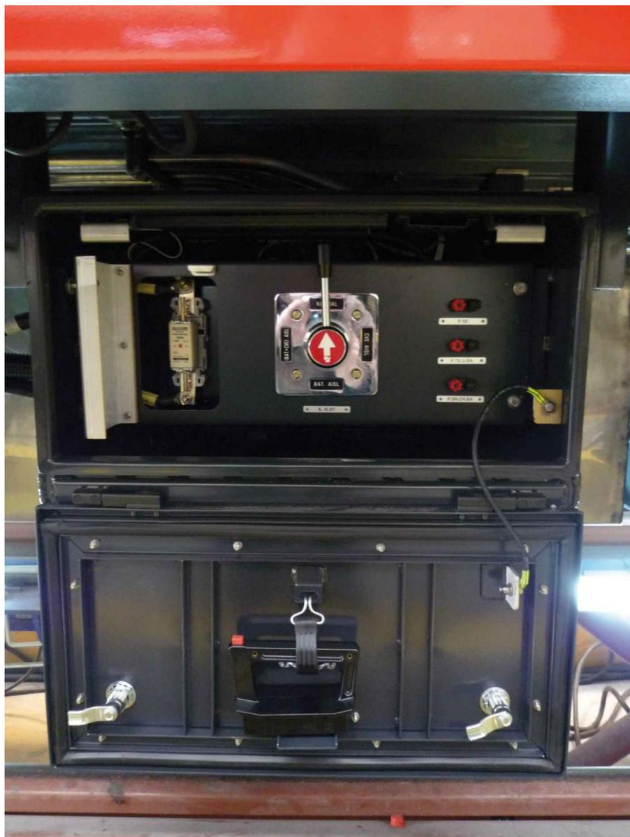
**Figura 3-29. Cofre auxiliar de baterías (Hoja 2 de 2).**
