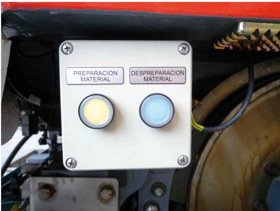
**Figura 3-32. Caja pulsadores preparación y despreparación material (Hoja 2 de 2).**
